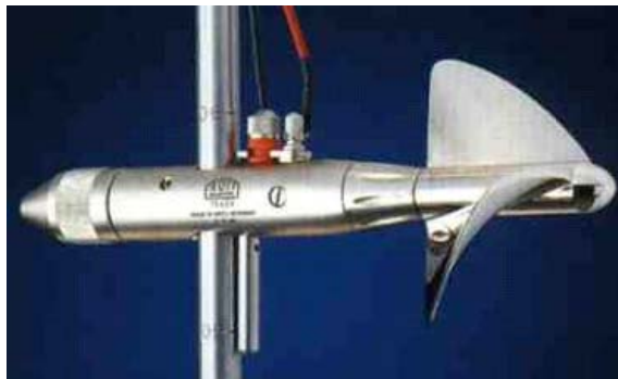
Abb. 16: Ott-Messflügel (aus Katalog der Firma Ott Messtechnik)
